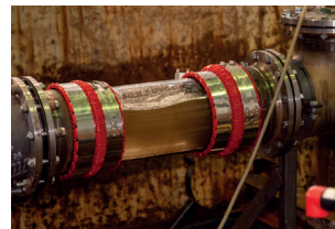
Figuur 6 Plexiglas buis met gasbel
