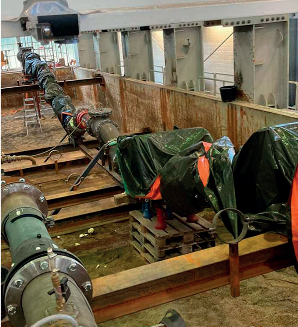
Figuur 10 Een overzicht van de testopstelling bedekt met plastic folies om de schadescenario's te verbergen en de deelnemers een blinde test te bieden.
