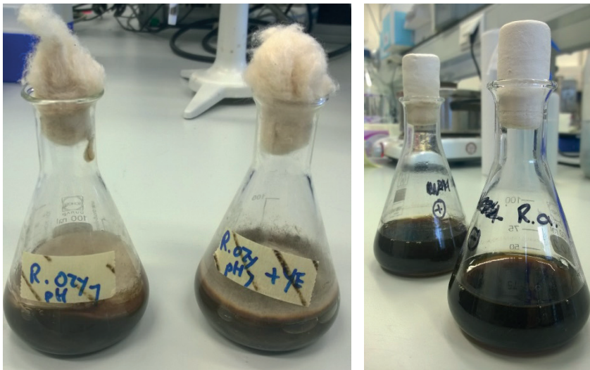
FIGUUR 8.38 LINKS EEN CULTUUR MET PH-CORRECTIE, ZONDER GISTEXTRACT (LINKS) EN MET GISTEXTRACT. DE WITTE LAAG BOVENOP DE VLOEISTOF IS DE GROEIENDE CULTUUR. RECHTS EEN CULTUUR ZONDER PH-CORRECTIE, ACHTER MET GISTEXTRACT, VOOR ZONDER
