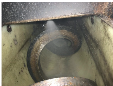
FIGUUR 8.28 TESTEN VAN NOZZLES IN DE VIJZEL
